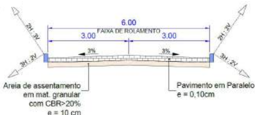
Figura 12: Exemplo de seção-tipo para pavimentação em paralelo. Fonte: SECOB, 2023.
