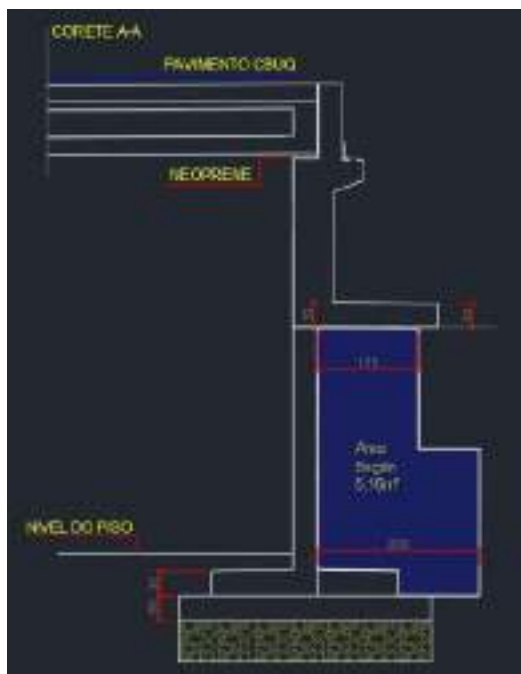
Figura 5 – Concreto a ser lançado em substituição ao solo-cimento
