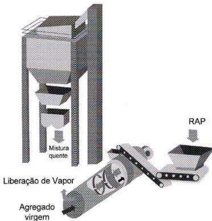
Figura B4 – RAP Frio em Usinas Gravimétricas – Adição de RAP em um anel de reciclagem
