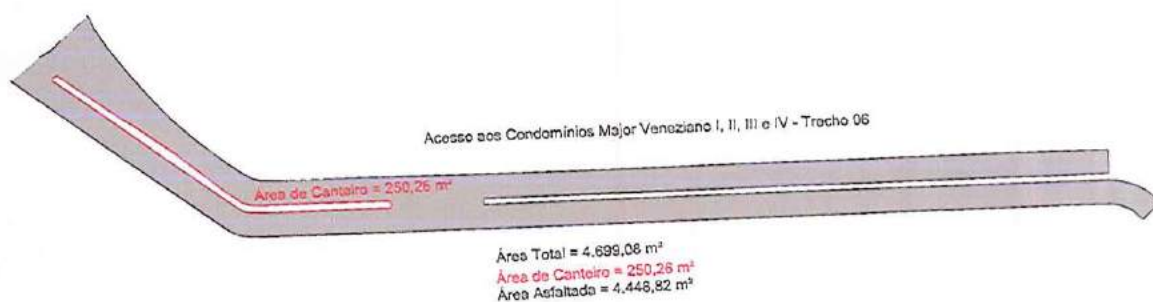
02 – Planta Baixa com Pavimentação Asfáltica (Capa)
