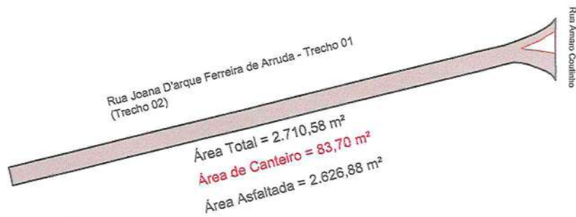
02 - Planta Baixa com Pavimentação Asfáltica (Capa)
